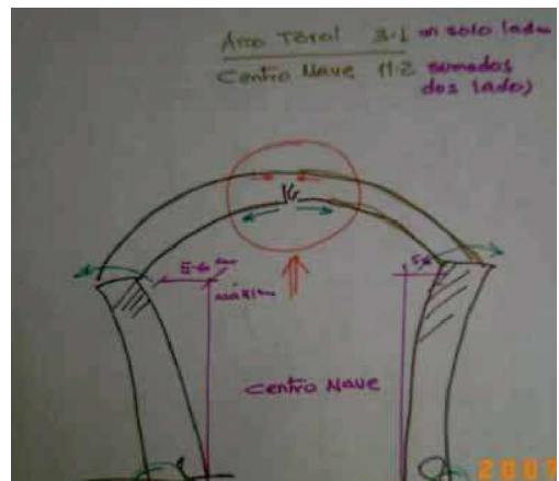
Figura 4. Fisura del arco en la clave del intradós Fuente: restauradora Carolina Leiva Fierro
