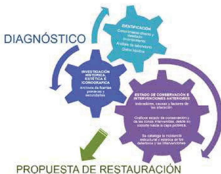
Figura 10 . Método generador de diagnóstico para pintura mural aplicado a la Catedral de Pasto Fuente: Restauradora Carolina Leiva, Arq. David Castillo
