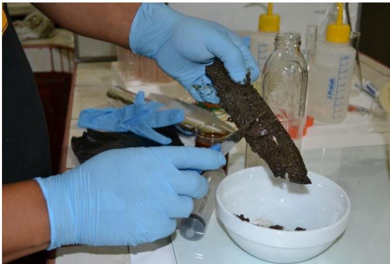
Figura 8. Elaboración de la pasta de sedimento bacteriano.
