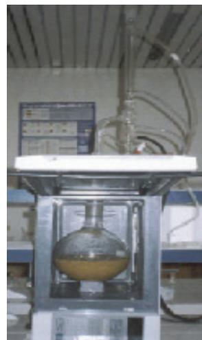
FIGURA 1. Montaje para realizar hidrodestilación asistida por radiación con microondas. Laboratorio de Productos Naturales Universidad de Nariño.
