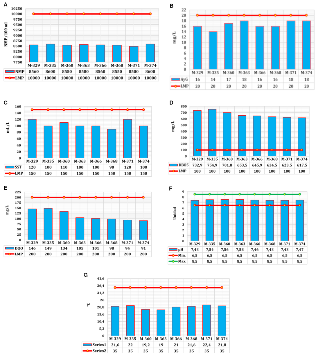
Figura 1. Comparación de parámetros del efluente con los Límites Máximos Permisibles (LMP) establecidos por la normativa peruana. A: CT, B: AyG, C: DQO, D: DBO 5 , E: SST, F: pH, G: Temperatura
